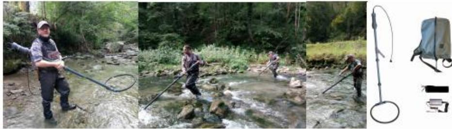
**Figure 13 : Prospection mobile à l'aide d'antennes de type backpack (source image de droite : Oregon RFID).**
