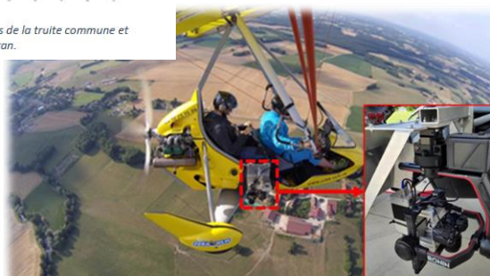
Stabilisateur embarquant les capteurs optique et thermique installés sur le côté de l’ULM. (Crédit : S. Jura ULM®).
